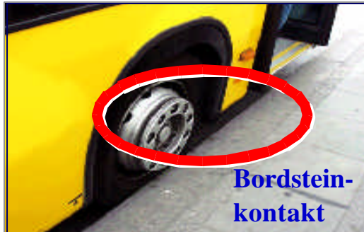
Abb. 3: Bordsteinkontakt führt zu Reifenschäden
